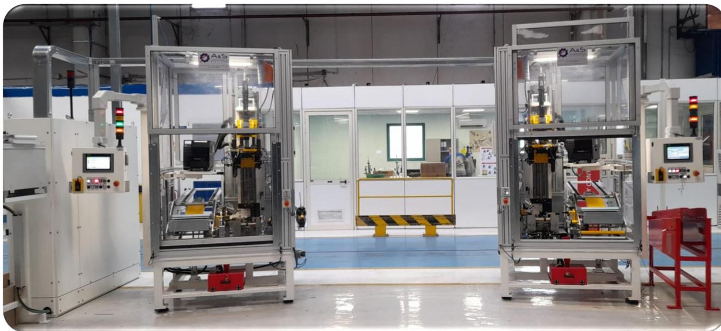
Banchi di assemblaggio ammortizzatore anteriore dx e sx
