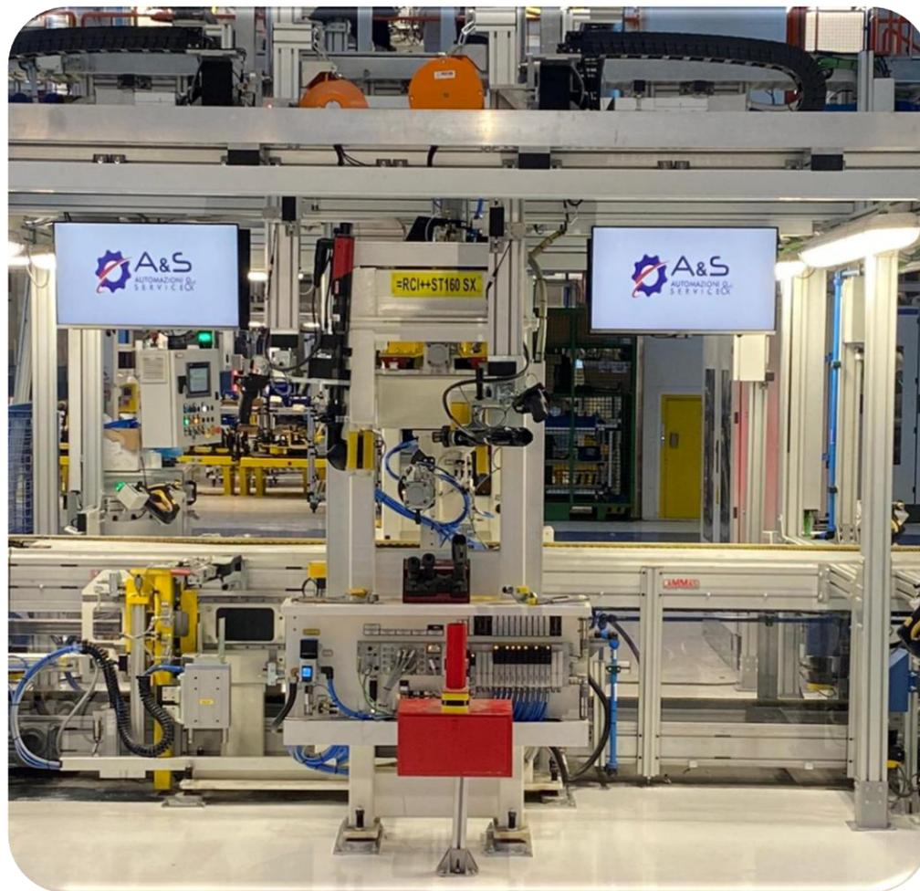
Pallet di trasporto elemento su linea di trasporto in fase di assemblaggio
